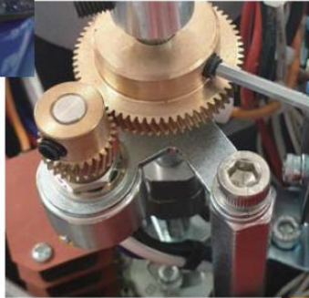
Modifier la valeur du potentiomètre en modifiant la vitesse
