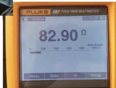
vérification du potentiomètre
